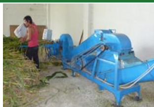
クラッシュマシン 5mm~10mm均等カット 短くすることで密度が高まり、 良質な醗酵を促進させます。
